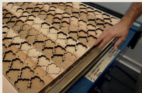
Nos ateliers sont équipés de machines à bois à découpe laser, fascinantes de précision. (4)
